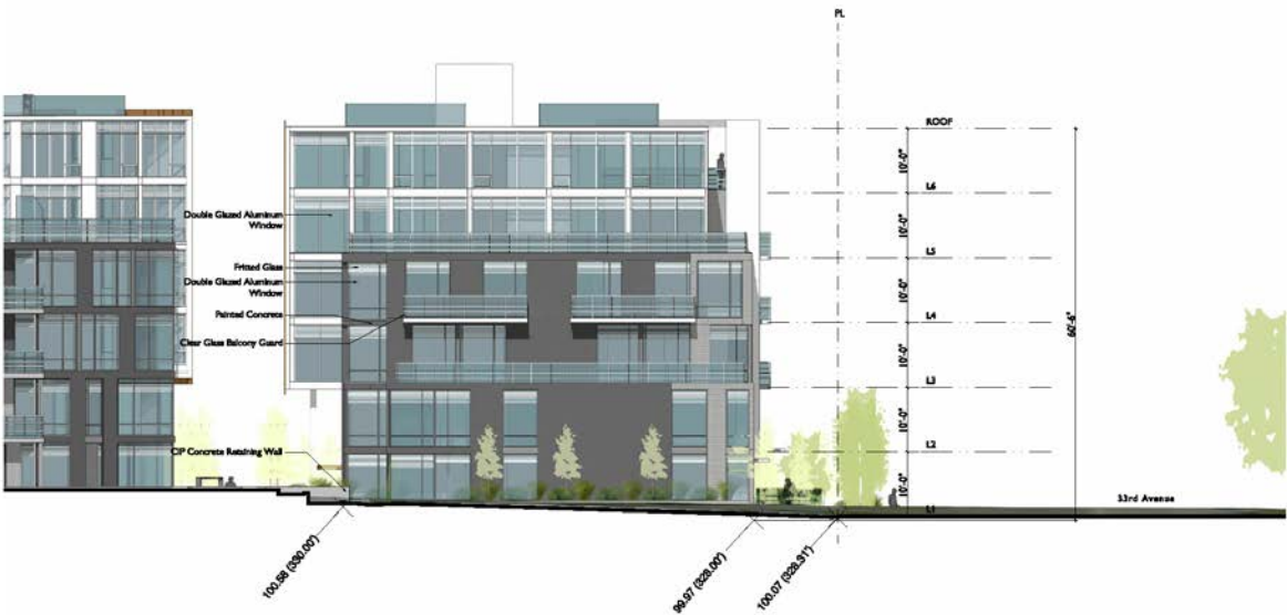
Building B East Elevation (Lane)
